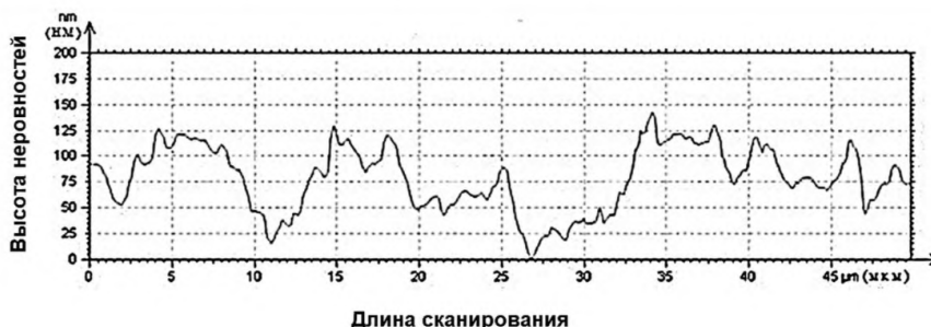
Рисунок 4. Сканированный профиль боковой поверхности зуба без обработки
