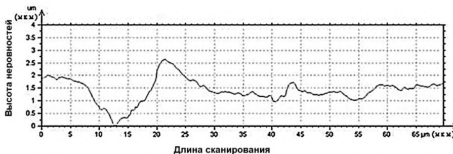
Рисунок 5. Сканированный профиль боковой поверхности зубьев линтерных пил после абразивоструйной обработки
